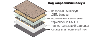
Рис. Схема монтажа теплого пола CALEO под ковролин или линолеум
